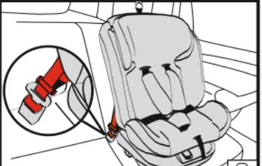
Надавите на автокресло, чтобы оно плотно прилегало к спинке сиденья автомобиля. Натяните ремень безопасности по всей длине и зафиксируйте его диагональную часть с помощью фиксатора штатного ремня максимально близко к пряжке ремня безопасности автомобиля.
