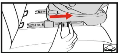
Чтобы отстегнуть крепления ISOFIX автокресла от нижних креплений ISOFIX автомобиля, необходимо нажать на кнопки фиксаторов креплений ISOFIX и задвинуть крепления ISOFIX в транспортировочное положение.
