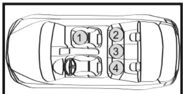
Автокресло разрешено устанавливать на сиденья, направленные в сторону движения автомобиля.
