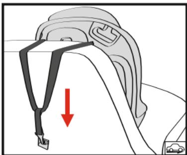
Закрепите верхний страховочный трос ISOFIX в точке крепления, для этого раскройте крюк-карабин и зацепите его за точку крепления, избегая перекручивания ремня. Проверьте надежность фиксации. Натяните ремень, потянув за свободную лямку.
