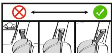
**!** При установке по направлению движения с использованием штатного 3-х точечного ремня безопасности автомобиля необходимо проконтролировать, чтобы верхняя точка крепления ремня безопасности находилась на уровне или позади детского автокресла.
