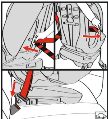
Протолкните пряжку ремня безопасности автомобиля в ближайшую прорезь для ремня безопасности, а затем протяните его по спинке, выньте через другую прорезь и пристегните его.
